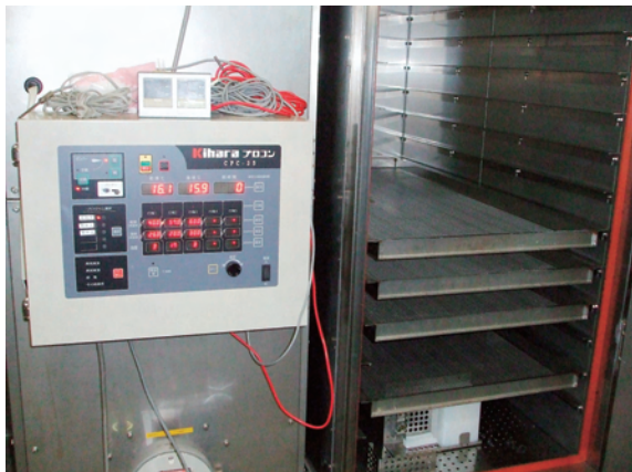
しいたけ乾燥機（全自動乾湿球制御操作盤付）
