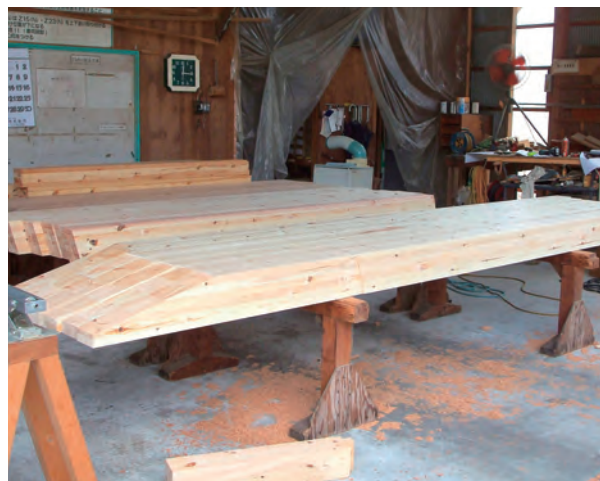
▲左写真の加工機でプレカットされた木材
