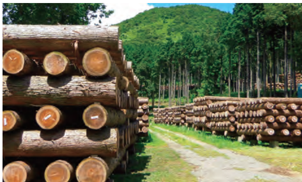
伐採した杉材を玉切りし、1年間太陽と風のみで乾燥させる「輪掛け乾燥」の様子 (大分県日田市)
