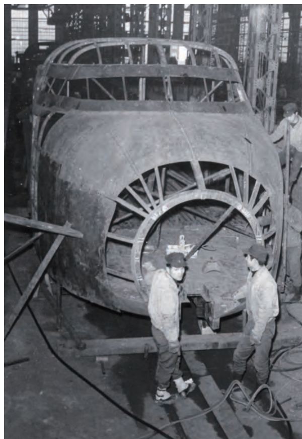
▲0系新幹線試作車両の先頭構体
