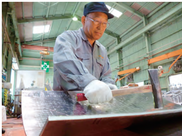
▲打ち出し板金の作業風景
