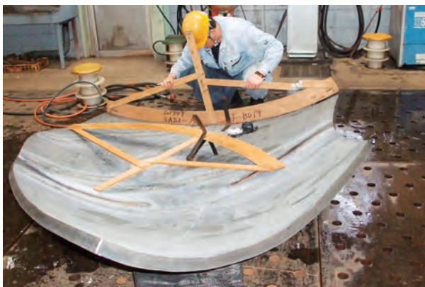
▲鋼板の形状確認
