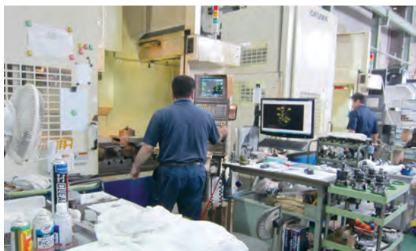
左側にある機械がマシニングセンター。 このレイアウトで、担当者一人が全て段取りする（座標計算中）
